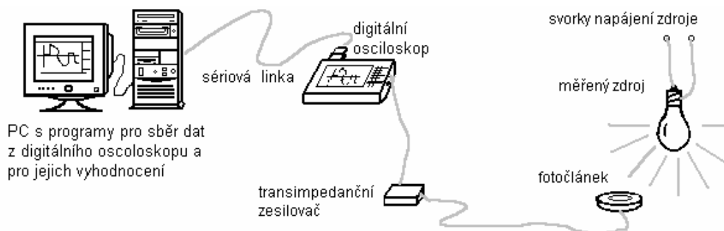
Obr. 5-41– Ideové schéma zapojení měřicího pracoviště
